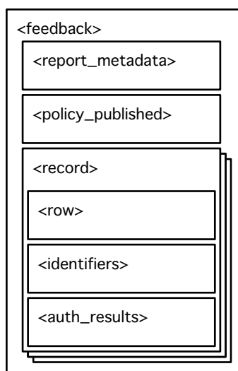
図 1.11 DMARC 集約 (aggregate) レポートの XML Schema
